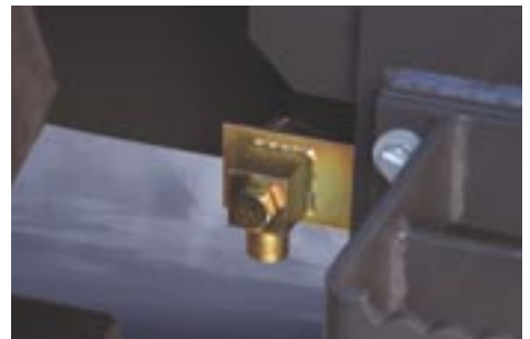
Aftapopeningen voor motorolie en koelvloeistof De aftapopeningen zijn op goed bereikbare plaatsen aangebracht om het ledigen te vergemakkelijken zonder gevaar voor milieuverontreiniging.
