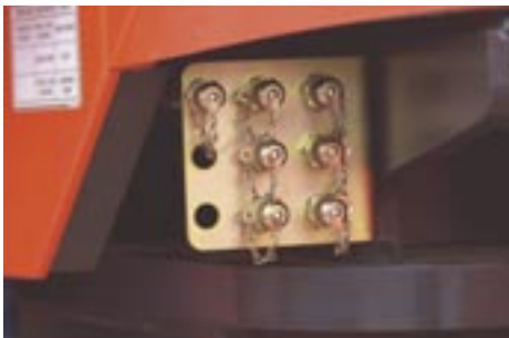
Hydraulische bedieningselementen De drukkregelkleppen zijn gegroepeerd (hoofddruk, stuurdruk, remdruk).
